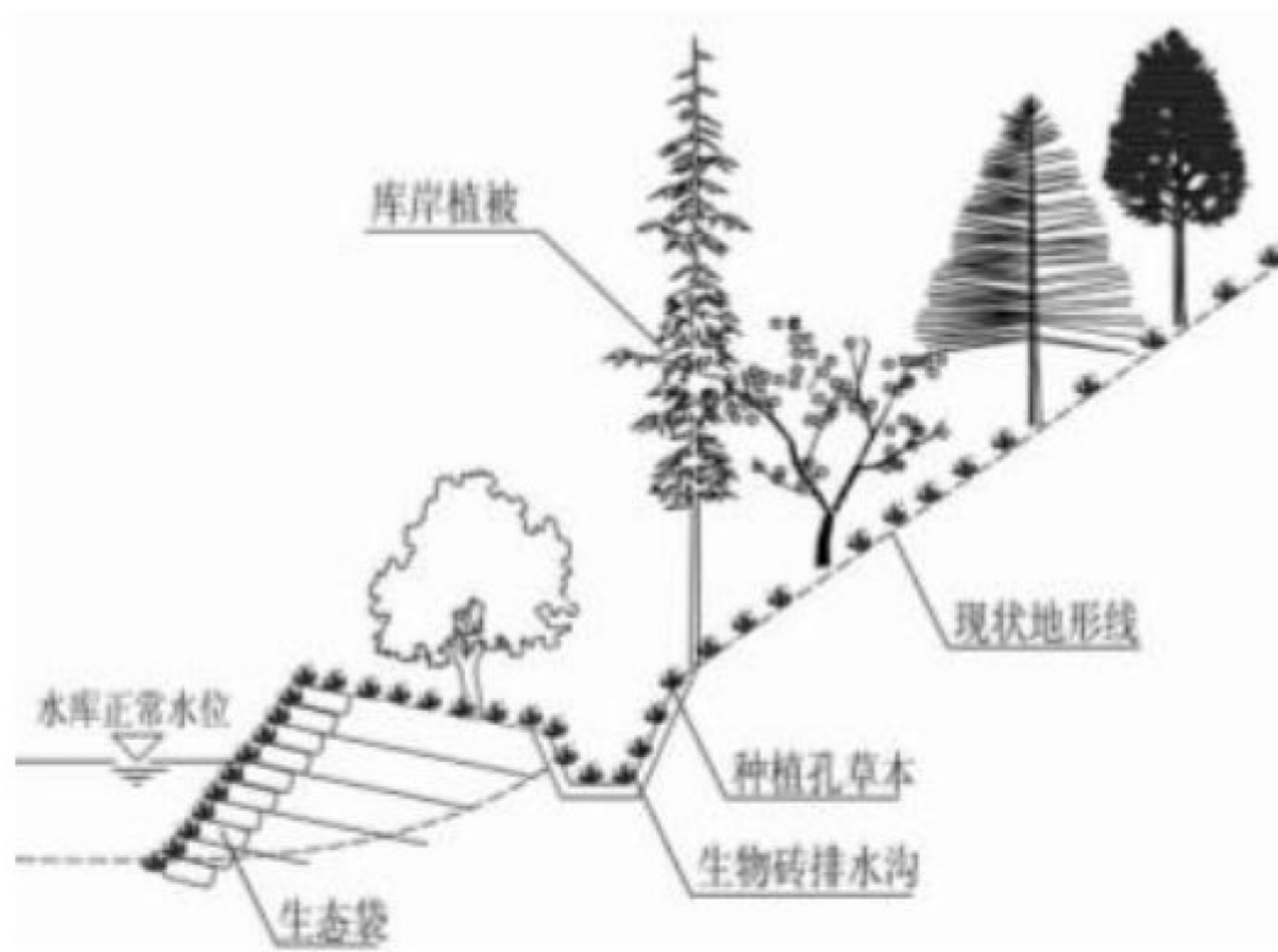
图 2 生物砖排水沟在生态护坡中的应用
